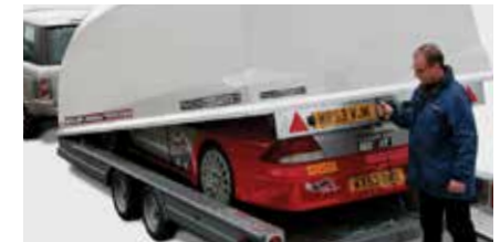
Rostfreies Stahl-Haubenschloß, Gasfederunterstütztes Öffnen/Schließen der Haube.
