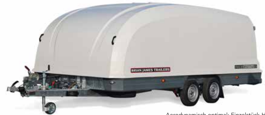
Aerodynamisch optimal: Einzelstück-Haube. Reduziert Windwiderstand und Spritverbrauch.
